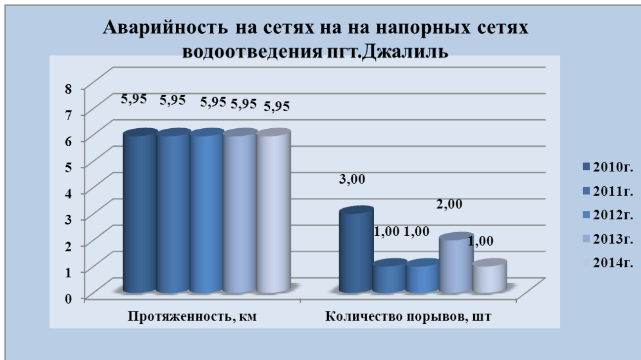
Рис.25 Аварийность на сетях водоотведения пгт. Джалиль
