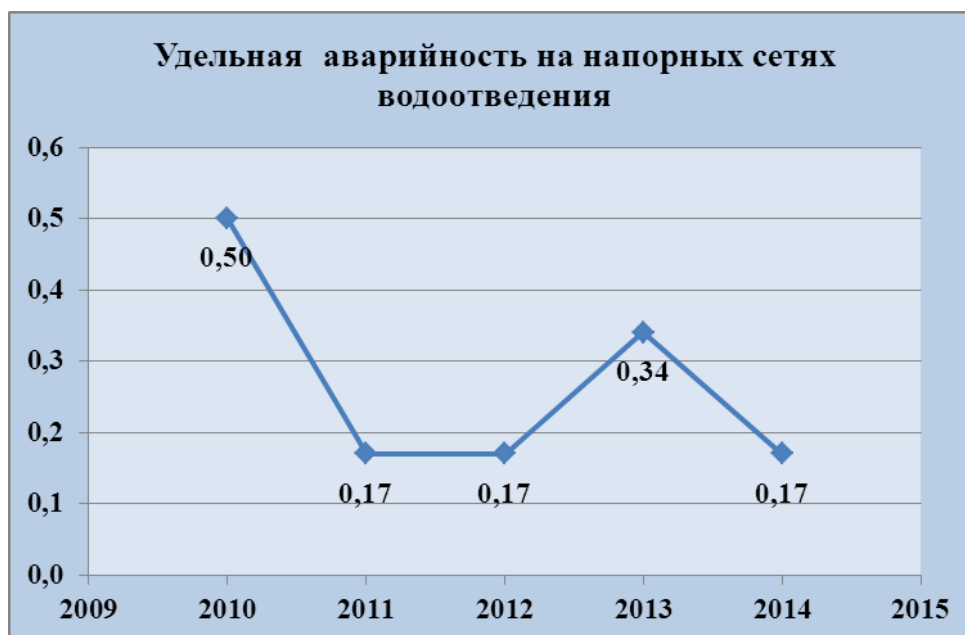
Рис.26. Динамика удельной аварийности пгт. Джалиль на сетях водоотведения.
