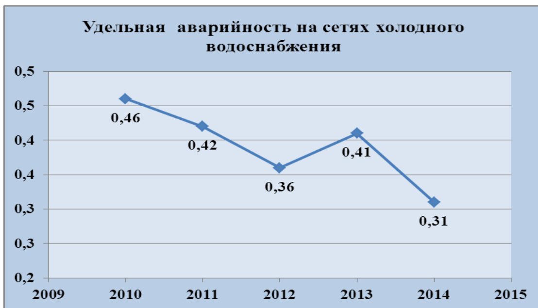
Рис.5. Динамика удельной аварийности пгт. Джалиль на сетях холодного водоснабжения
