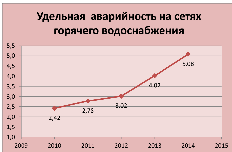
Рис.7. Динамика удельной аварийности пгт. Джалиль на сетях горячего водоснабжения.
